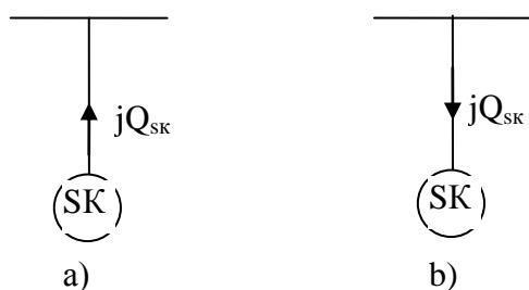
1.2.1-rasm. Sinxron komplekslarni oʻta qoʻzgʻatish tartibi (a) va qoʻzgʻatishga etmagan (b) tartibda ishlashi
