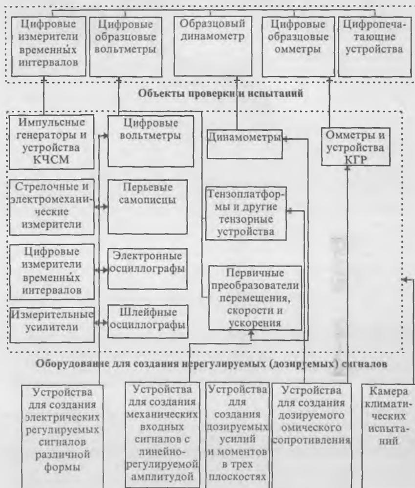
Рис. 16. Структура метрологического (поверочного) стенда для снятия статических характеристик приборов и устройств
