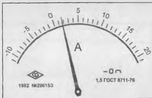
Рис. 11. Лицевая панель амперметра с равномерной шкалой
