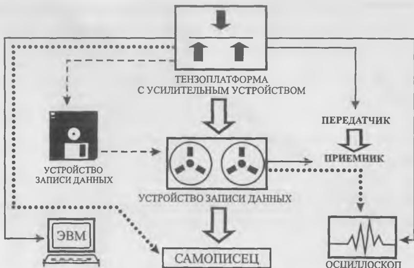
Рис. 12. Схема электронно-измерительной системы для измерения опорных реакций в спорте
