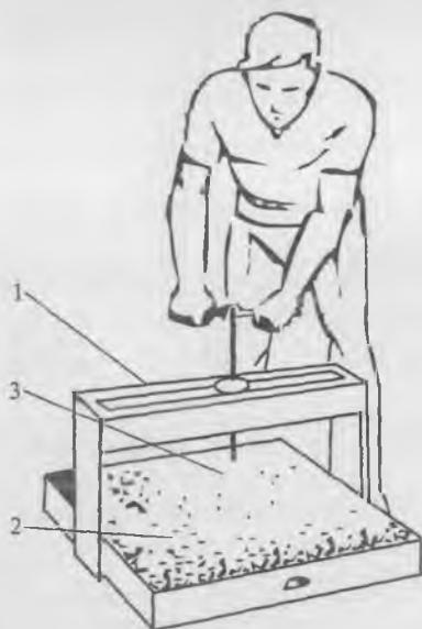
Рис. 20. Общий вид стенда для проверки и метрологической аттестации технических средств измерения силы, развиваемой спортсменом:
