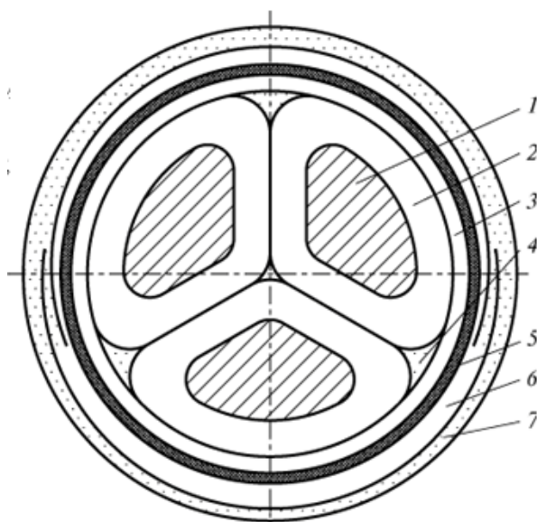
17-rasm. Belboq izolyatsiyali va sektor simlari zichlangan uch simli kabellar. 1-tok oʻtkazuvchi pay. 2-faza izolyatsiyasi. 3-ustki izolyatsiya. 4-toʻldirgich.5-qoʻrqoshinli qatlam. 6-himoya yostiqchasi. 7-ikkita poʻlat lentadan iborat himoya qatlami.
