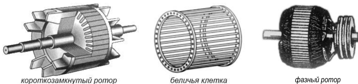
Рис. 6.3. Конструкции короткозамкнутого и фазного роторов
