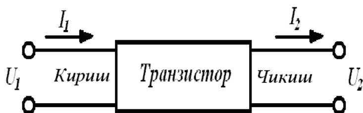
1 – rasm. Tranzistorni chiziqli to'rt qutblilik sifatida ko'rsatilishi
