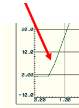
4-rasm. Ideal diod VATini tadqiq etilayotgan qismining kattalashgan ko'rinishi
