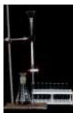
Kolonkali xromatografiya usulida moddalarning ajralishi
