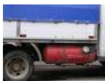
Avtomobilda propan to'ldirilgan yonilg'i baki
