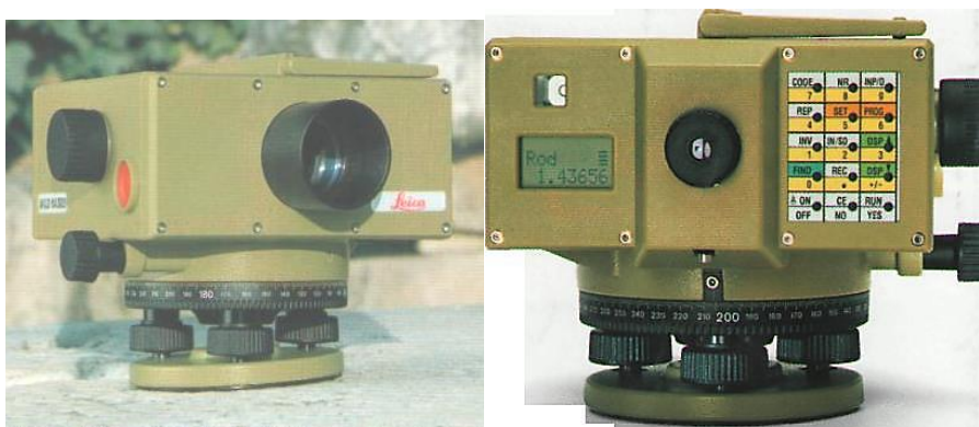
2.18–rasm. Elektron nivelir NA 2000 da "Wild" (Shveysariya)
