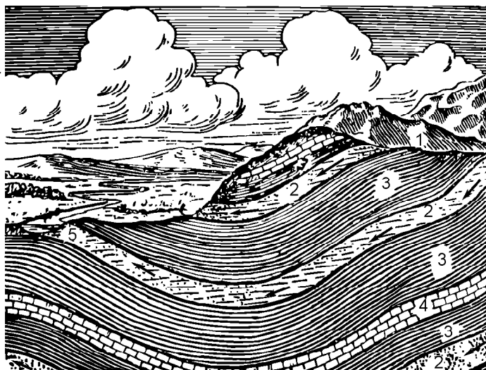
12.8-rasm. Atmosfera yog‘inining yer qatlamlariga singishi natijasida vujudga kelgan yer osti suvlari oqimi sxemasi (N.N.Maslovdan, ba‘zi o‘zgartirishlar bilan). 1 — yer osti suvini paydo qilish hududi; 2 — yer osti suvi va uni oqim harakat yo‘nalishini ta‘minlovchi g‘ovak tog‘ jins qatlami; 3 — suvni o‘zidan o‘tkazmaydigan tog‘ jins qatlamlari; 4 — yer osti suv oqimining yer yuzasiga buloq holatida chiqishi; 5 — yer osti suvining yer yuzasiga chiqib, daryo suviga qo‘shilishi va uni to‘yintirish holati.
