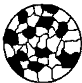
Рис. 12.2. Микроструктура сплавов двух металлов, образующих механическую смесь.
