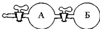
Рис. 6.4. Сосуд, состоящий из двух частей: в части A находится разреженный газ, в части B — вакуум.
