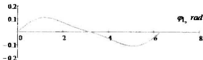
3.7-rasm. Polzun chiziqli tezligining o'zgarish qonuniyati
