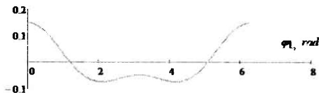
3.8-rasm. Polzun chiziqli tezlanishining o'zgarish qonuniyati
