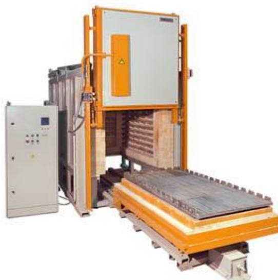
7.10-rasm. PVP-1000/12.5M tipidagi kamerali mexanizatsiyalashgan elektr pech: 1 – karkas; 2 – qoplama; 3 – elektroqizdirgich; 4 – eshik; 5 – teleshka; 6 – yo‘naltiruvchi rels; 7 – termopara; 8 – elektropechni boshqarish shkafi
