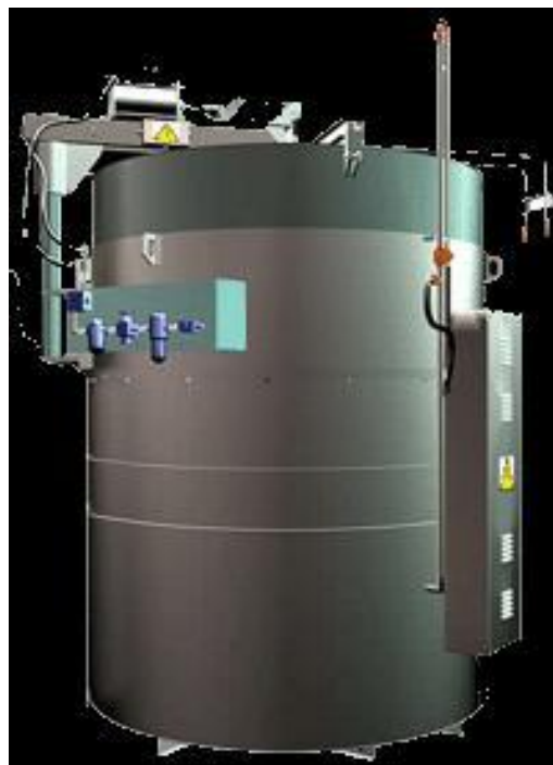
7.5-rasm. Metallarni azotlash jarayonini o'tkazishga mo'ljallangan mufelsiz shaxtali pechning umumiy ko'rinishi
