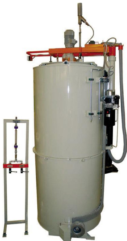
7.4-rasm. Gazli sementatsiya jarayonini o'tkazishga mo'ljallangan mufelli shaxtali pechning umumiy ko'rinishi
