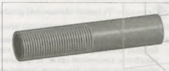
Рис. 28.22. Изображение резьбы на модели
