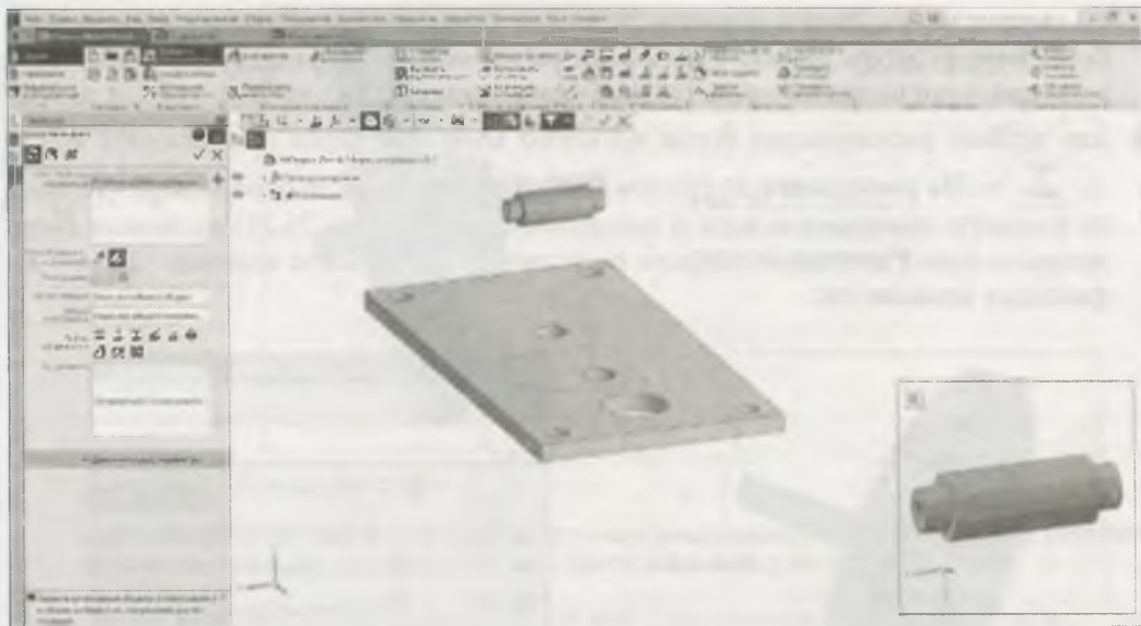
Рис. 25.20. Окно в режиме вставки компонента
