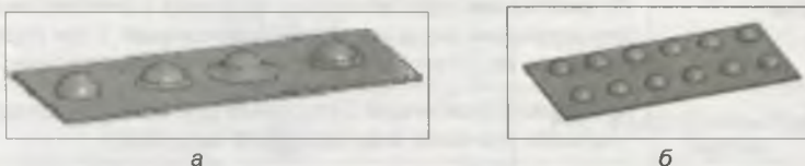
Рис. 29.47. Варианты пуклевки (а); массив пуклевок (б)
