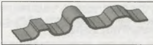
Рис. 29.44. Формы сечения буртика
