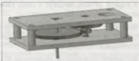
Рис. 25.28. Модель сборки Редуктор
