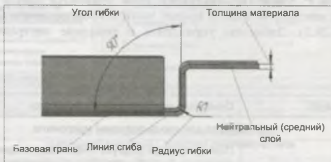
Рис. 29.2. Параметры листовой детали
