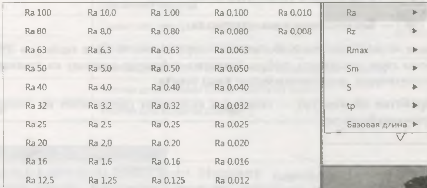
Рис. 13.6. Панель с раскрытым списком значений шероховатости
