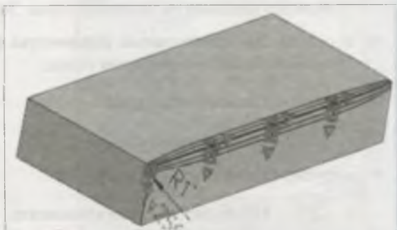
Рис. 21.4. Скругление с переменным радиусом
