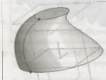
Рис. 19.28. Элементы по сечениям с использованием направляющей
