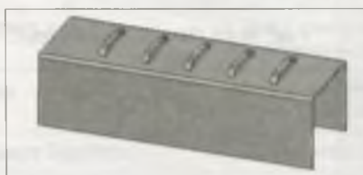
Рис. 29.41. Результат построения жалюзи типа Вытяжка
