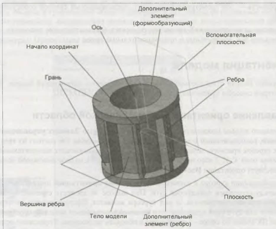
Рис. 19.3. Объемные элементы твердотельной модели
