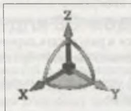
Рис. 19.4. Элемент управления ориентацией в изометрии
