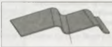
Рис. 29.19. Варианты создания подсечки по линии и по ребру
