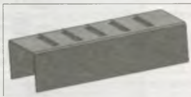
Рис. 29.42. Результат построения жалюзи типа Подрезка
