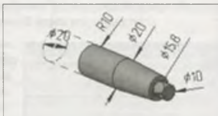
Рис. 28.7. Варианты построения диаметральных размеров на модели Вал 2
