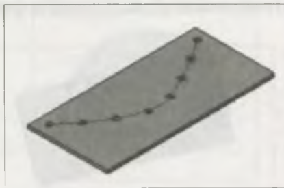
Рис. 21.29. Модель с одним отверстием (а); массив отверстий вдоль кривой (б)
