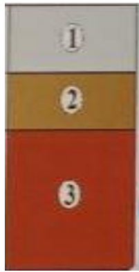
1.11-rasm. 1-sement bilan ishlov berilgan grunt; 2-sanoat chiqindi materiallari bilan grunt qorishmasi; 3-yo‘l poyi.
