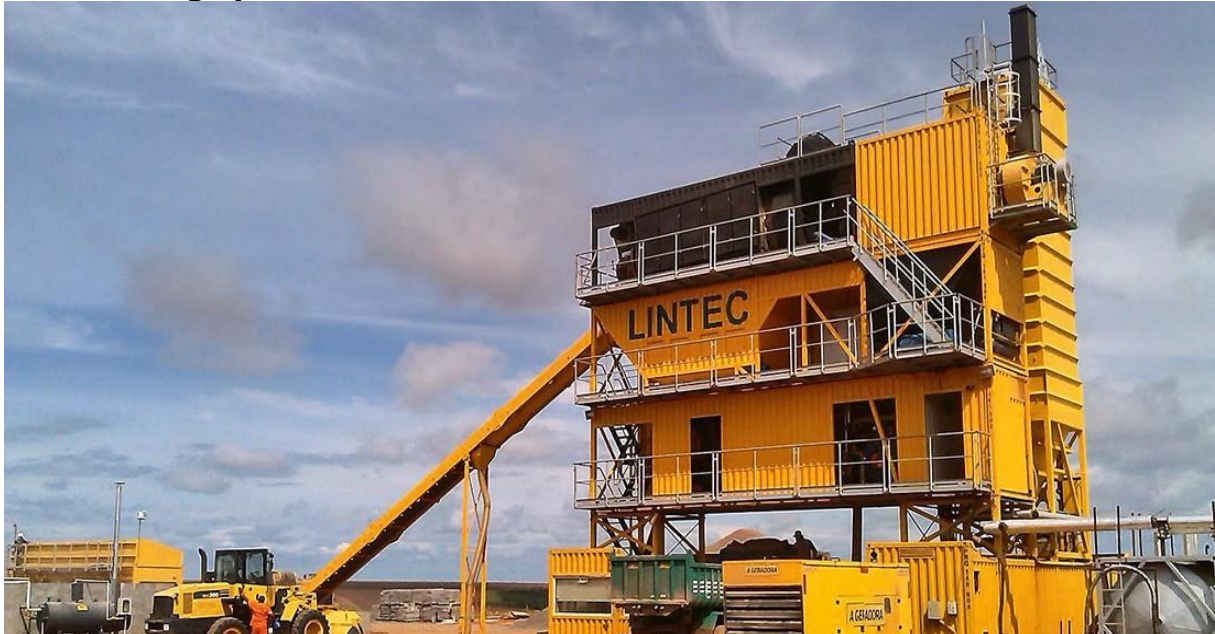
3.10-rasm. Konteyner turidagi Lintec asfaltbeton qorishmalarini tayyorlash zavodi
