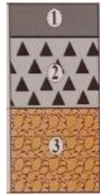
1.13-rasm. 1-mayda donali zich issiq asfaltbeton; 2-sement bilan ishlov berilgan chaqiqtosh-qum qorishmasi; 3-qum-shag‘al qorishmasi.
