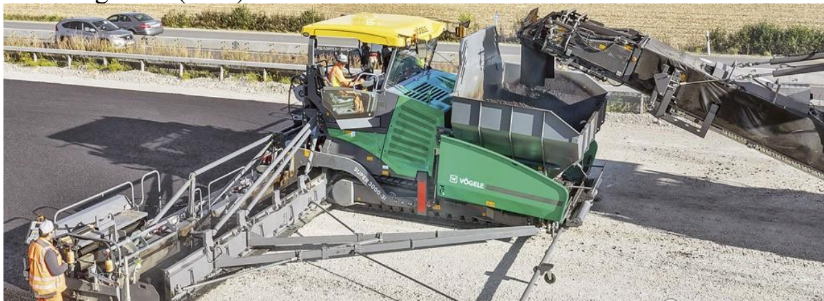
1.30-rasm. Voegle kompaniyasining SUPER 300-3 markali asfaltyotqizgichi
