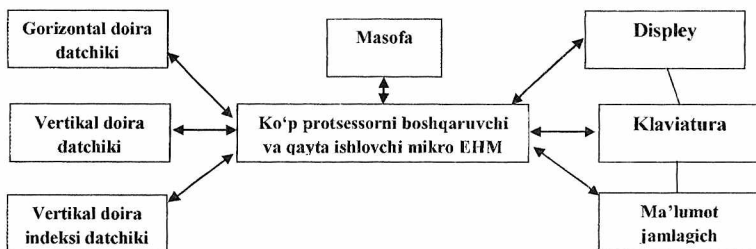
20-rasm. Funksiyali elektron taxometrda ma'lumotlarni qayd etish vositalari.
