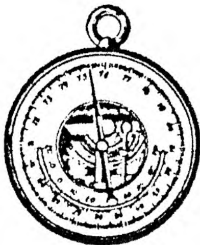
7-расм. Барометр-анероид БАММ-1
