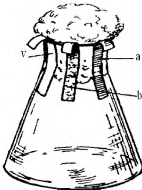
23 - rasm. Ammonifikatsiya jarayonini tekshirish uchun tajribaning qo'yilishi: a - qizil lakmus qog'oz; b - oksalat kislota ( H_2C_2O_4 ) tuzi eritmasi shimdirilgan filtr qog'oz; v - qo'rg'oshin atsetat ( Pb(CH_3COO)_2 ) tuzi eritmasi shimdirilgan filtr qog'oz.
