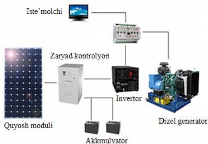
1.3-rasm. Ta'minot manbasining kombinasiyalashgan tizimi sxemasi
