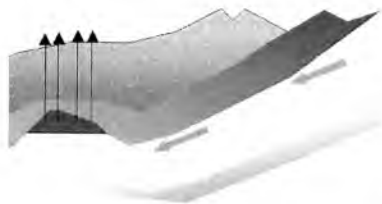
2.3-rasm. Suv bosimi rejimida qatlamni ishlatish sxemasi
