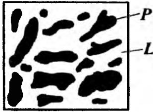
2.1-rasm. Evtetik oq cho‘yan strukturasi.
