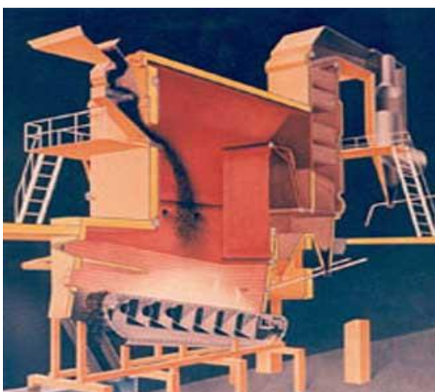
4.5-rasm. YUTSQQ o`txonali KV-TS-20 suv isituvchi qozon rekonstruktsiyasi
