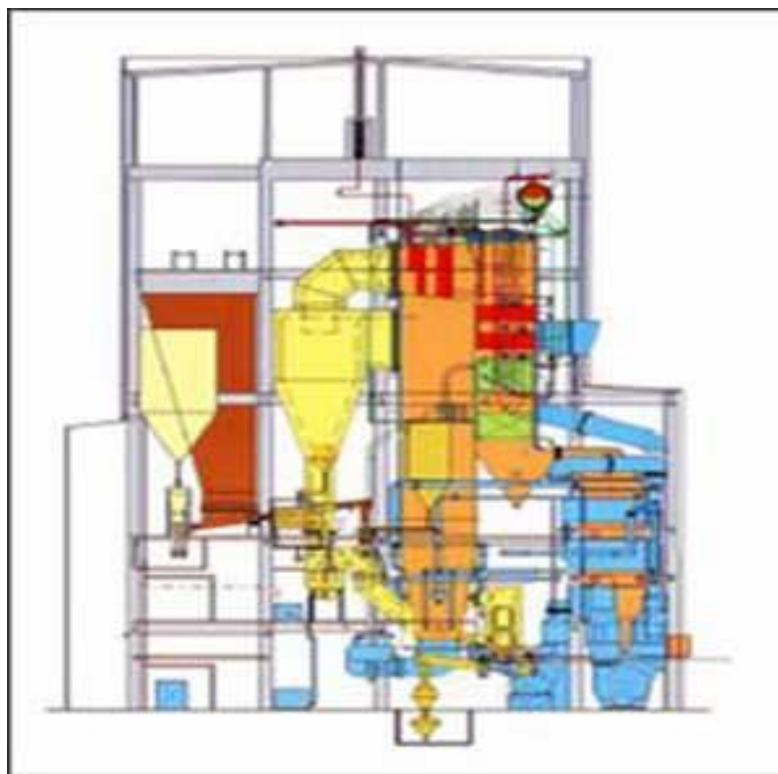
4.4-rasm. Statsionar qaynash qatlamli bug' ishlab chiqaruvchanli 75 t/s bo'lgan «Rafako» (Polsha) firmasida ishlab chiqarilgan qozon
