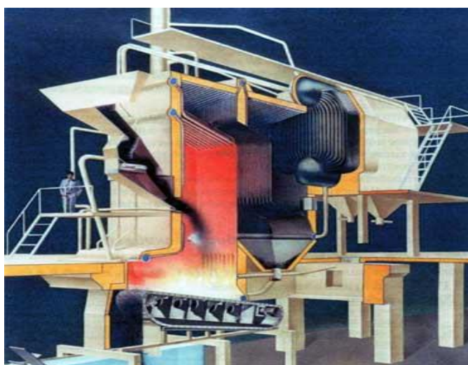
4.6-rasm. YUTSQQ o'txonali DKVr-20-13 bug' qozonining rekonstruktsiyasi
