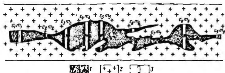
Рис. 55. Схема опробования шторка при неравномерном расположении проб и неравномерной мощности тела полезного ископаемого
