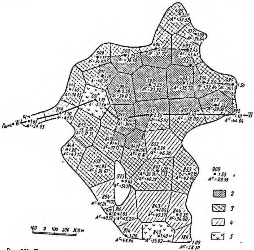
Рис. 221 Подсчет запасов одного из участков угольного месторождения Подмосковного бассейна по методу многоугольников
