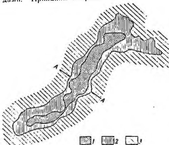
Рис. 96. Схематический план залежи бокситов (по В. И. Смирнову) 1 — малокальциевые бокситы (абразивное сырье); 2 — бокситы; 3 — вмещающие породы
