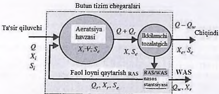
65-rasm. To'liq aralashtiruvchi reaktordagi biomassa moddiy balansi uchun tizim chegaralari.
