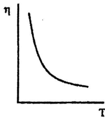
2.40-chizma. Qovushqoqlikning haroratga bog'liqligi
