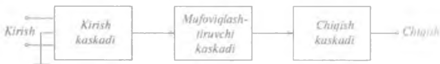
2.15-rasm. Uch kaskadli OKning funksional sxemasi.
