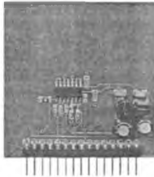
10.27-rasm. Analog kuchlanish komparatorlari xarakteristikalarini tadqiq etishda qo'llaniladigan Lab7A modulining tashqi ko'rinishi.
