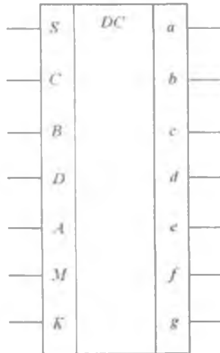
5.16-rasm. Ikkilik-o'nlik kodni 7 segmentli kodga o'zgartiruvchi deshifratör shartli belgisi.
