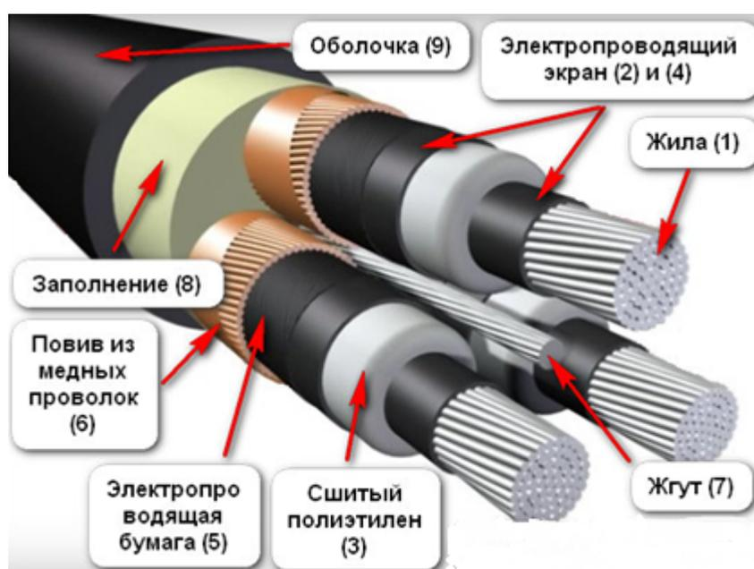
Рис. 2. Пример конструкции силового кабеля
