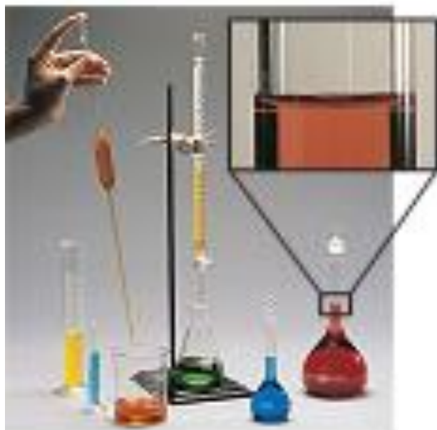
1.5-rasm. Laboratoriya o'lchov shisha idishi. Chapdan o'ngga quyidagilar joylashgan: ikkita graduirlangan silindrlar, pipetka (eksperimentator qo'lida), kolbaga aniq miqdorlardagi suyuqlikni o'lchab solish uchun byuretka, ikkita o'lchov kolbalari.
