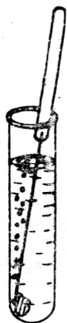
13.5-rasm. Kislotalarda kimyoviy toza ruxning mis yoki platina simi bilan kontaktda bo'lganida erishi.
