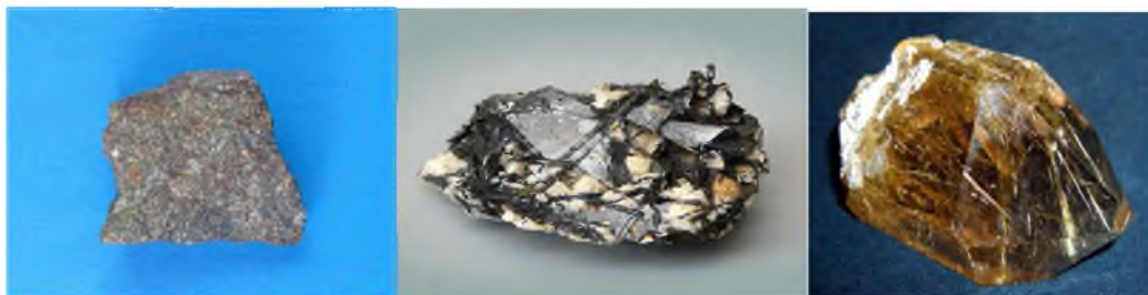
26.2-rasm. Titanning a) titanomagnetit \text{FeTiO}_3 \cdot n\text{Fe}_3\text{O}_4 , b) ilmenit \text{FeTiO}_3 , d) rutil \text{TiO}_2 birikmalari
