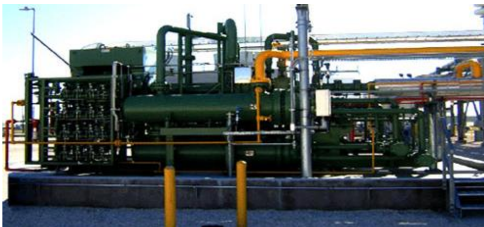
7.16 - rasm. 4-chi bosqichli 2-rotorli markazdan qochma siquv (dojimli) gazli kompressor
