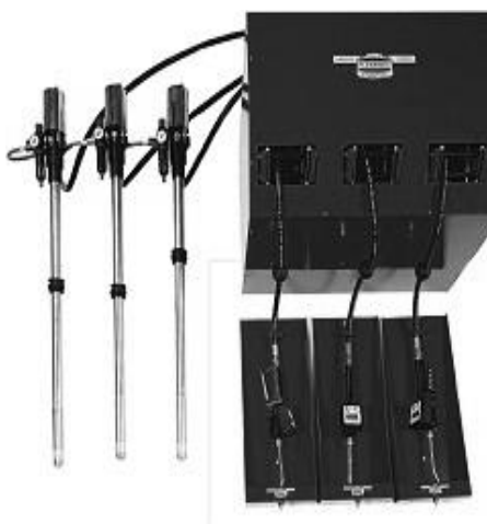
16.1-rasm. Qo‘zg‘almas suyuq moy tarqatish qurilmasi
