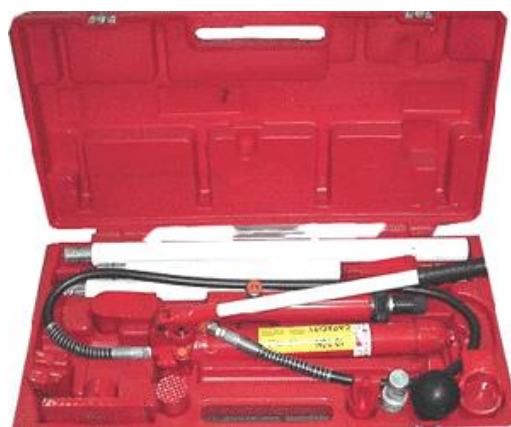
4.4-rasm. Kuzovlarni gidravlik to'g'rilash jamlanmasi
