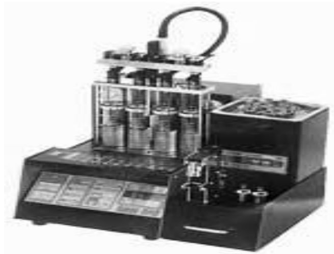
7.4-rasm. Avtomobil dvigatellarining 4 ta injektorini bir yo'la tekshiradigan ultratovushli A4DFV stendi
