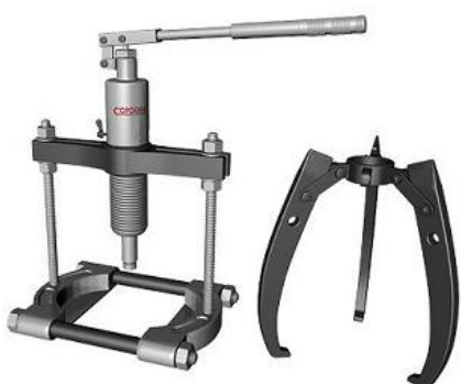
31.1-rasm. 12 tonnali gidravlik ko'p vazifali yechgich
