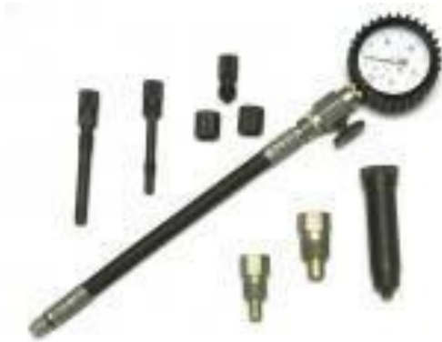
9.1-rasm. BEST-04UR modelidagi kompressometr va uning texnik tasniflari
