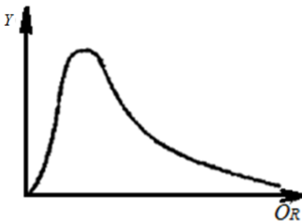
6.4-rasm. Maksvell egri chizig'i R - eksentrisitet yoki urushining o'zgaruvchan kattaligi.
