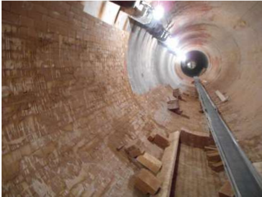
2.5-rasm. Ichki qismi qoplamasi o'tga chidamli g'ishtlardan tayyorlangan aylanuvchi barabanli pechning ko'rinishi.
