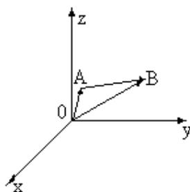
Рассмотрим теперь вектор  $\overrightarrow{AB}$ , начало которого  $A$  имеет координаты  $x_1, y_1, z_1$ , а конец  $B$  имеет координаты  $x_2, y_2, z_2$ , т.е.  $A(x_1, y_1, z_1); B(x_2, y_2, z_2)$ . Вектор  $\overrightarrow{AB} = \overrightarrow{OB} - \overrightarrow{OA}$ .
