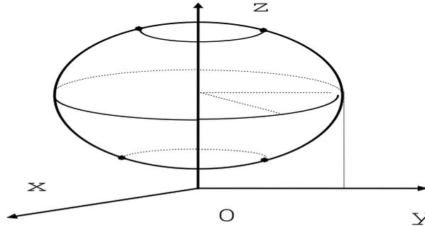
Пусть  $M(x, y, z)$  – любая точка поверхности вращения, через точку  $M(x, y, z)$  проводим перпендикулярную плоскость  $Q$  к оси  $Oz$ . Центром поверхности вращения на плоскости  $Q$  является точка  $O_1$ . Тогда  $|O_1M| = |O_1P| = |y_1|$ .
