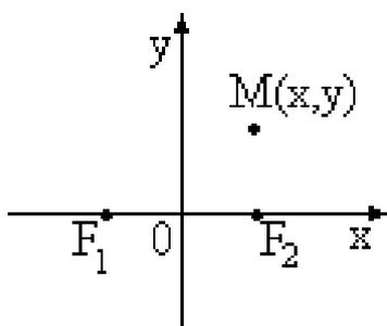
Пусть  $F_1(-c, 0)$ ,  $F_2(c, 0)$ ,  $M(x, y)$  – произвольная точка эллипса. По определению  $MF_1 + MF_2 = const$ . Обозначим эту константу через  $2a > 2c$ , то есть
