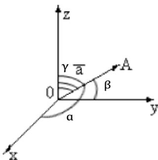
Пусть  $\vec{a}$  – вектор в пространстве, начало которого совпадает с началом декартовой системы координат. Пусть  $\alpha, \beta, \gamma$  – углы, образуемые вектором  $\vec{a}$  с координатными осями  $Ox, Oy, Oz$  соответственно. Косинусы углов, образуемых вектором с осями координат, называются *направляющими косинусами* этого вектора.
