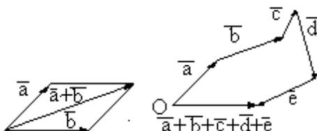
Понятие суммы векторов можно обобщить на случай любого конечного числа слагаемых. Из произвольной точки  $O$  откладываем вектор, равный первому слагаемому. В конце первого вектора помещаем начало второго, в конце второго – начало третьего и так далее. Вектор, соединяющий начало первого с концом последнего, является суммой данных векторов.
