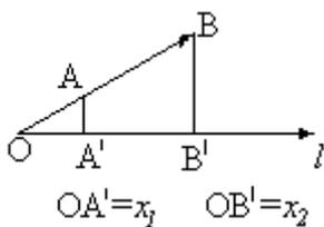
**1.3 Проекция вектора на ось.** Пусть  $l$  - произвольная ось,  $\vec{AB}$  - вектор на плоскости. Опустим из точек  $A$  и  $B$  перпендикуляры на ось  $l$ .  $A'$  – проекция точки  $A$ ,  $B'$  – проекция точки  $B$  на ось  $l$ . Пусть  $x_1$  – координата точки  $A'$ ,  $x_2$  – координата точки  $B'$ .
