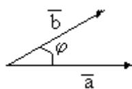
**Определение.** Скалярным произведением двух векторов  $\vec{a}$  и  $\vec{b}$  называется число, равное произведению модулей векторов на косинус угла между ними.
