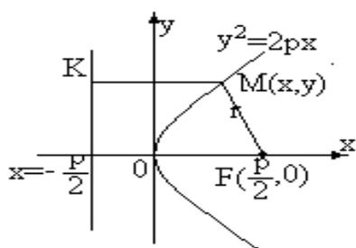
Так как координата  $y$  входит в уравнение параболы в квадрате, парабола симметрична относительно оси  $Ox$ .
