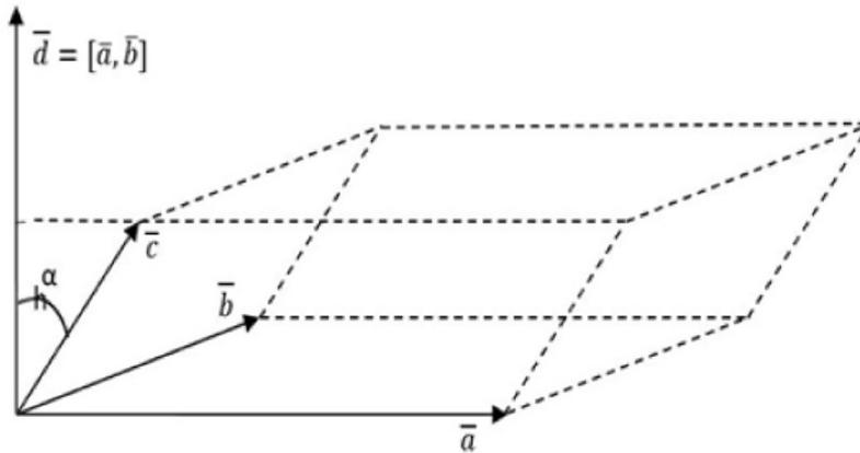
Смешанное произведение  $(\vec{a}, \vec{b}, \vec{c}) = ([\vec{a}, \vec{b}], \vec{c}) = |[\vec{a}, \vec{b}]| \cdot |\vec{c}| \cos \varphi = S \cdot |\vec{c}| \cos \varphi$ ,
