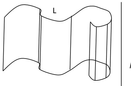
Прямая называется образующей цилиндрической поверхности, а кривая – направляющей. Если образующая параллельна оси  $Oz$ , а кривая лежит на
