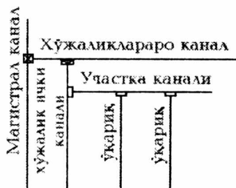
2.11 - расм. Суғориш тармоғи схемаси
