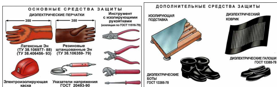
Рисунок 4.1.Изолирующие электрозащитные средства
