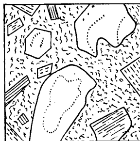
3-расм. Баъзи магматик жинслар структураси (12 марта катталаштирилган).
