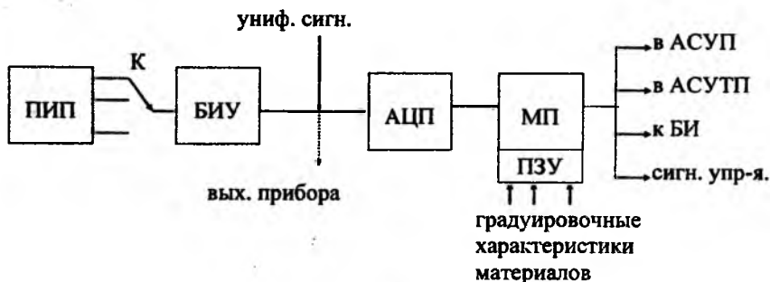
Рис.8.21. Блок-схема унифицированной системы средств измерения влажности, содержащий микропроцессор.
