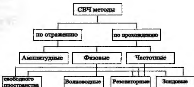
Рис.6.1. Классификация СВЧ методов измерения влажности твердых материалов и жидкостей
