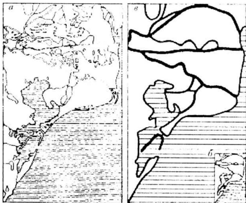
Рис. 72. Генерализация контуров дельты р. Дуная а – исходная карта масштаба 1:500 000; б – та же карта при уменьшении до масштаба 1:1 250 000; в – увеличение генера- лизованного изображения, показывающее сочетание отбора и обобщения линейных элементов и других аспектов геометрической генерализации
