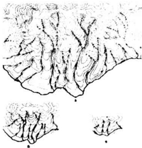
Рис. 76. Генерализация рельефа в горизонталях а – исходное изображение в масштабе 1 200 000; б – изображение в масштабе 1 500 000; в – изображение в масштабе 1:1 000 000
