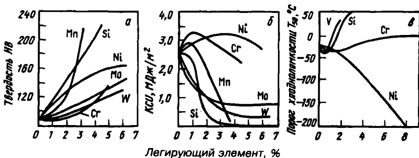
Рис. 118. Влияние легирующих элементов на свойства медленно охлажденного (нормализованного) феррита и порог хладноломкости:
