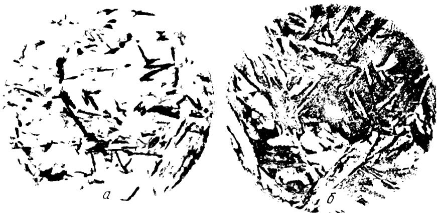
Рис. 101. Микроструктура мартенсита после закалки стали 45 от температуры 840 °C в воде:
