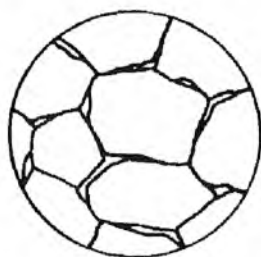
Рис. 5.10. Вырожденная эвтектика — прослойки второй фазы эвтектического происхождения вокруг первичных кристаллов
