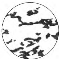
Рис. 9.6. Формы вермикулярного графита
