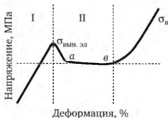
Рис. 11.4. Диаграмма растяжения для полимера в стеклообразном состоянии:
