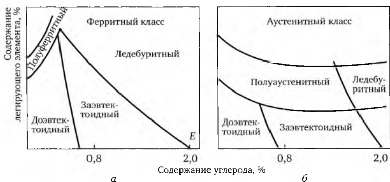
Рис. 9.3. Структурные диаграммы легированных сталей: а — ферритообразующие; б — аустенитообразующие
