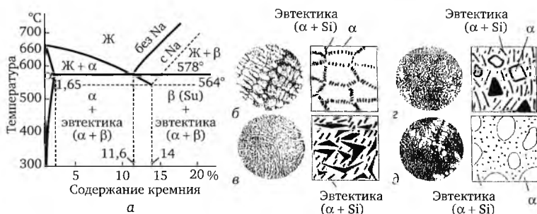
Рис. 10.3. Диаграмма Al—Si (а) и микроструктура силуминов: б — доэвтектический; в — эвтектический; з — заэвтектический; д — модифицированный
