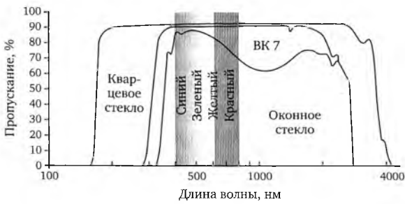
Рис. 11.8. Спектр оптического пропускания синтетического кварцевого стекла Suprasil 300 , оптического стекла BK 7 и обычного стекла. Спектр видимого света лежит в пределах от 400 до 800 нм
