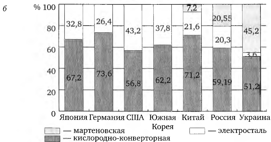
Рис. 1.4. Структура производства стали:
