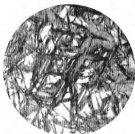
Рис. 8.16. Сталь У12. Структура M_{отп} и остаточный аустенит; первичные мартенситные иглы травятся неравномерно из-за выделения \epsilon -карбида ( \times 1500 )
