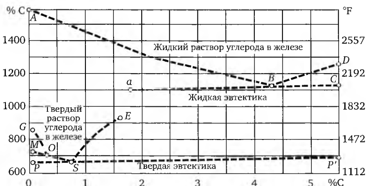
Рис. 7.15. Общеизвестная первая диаграмма железо — углерод (У. Робертс-Аустен, 1897 г.)
