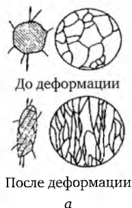
Рис. 3.6. Схема микроструктуры до и после деформации (а); б — микроструктура монокристалла кремнистого железа ( \epsilon \approx 1\% ); А и Б — плоские ряды винтовых дислокаций разного знака, \times 20\,000
