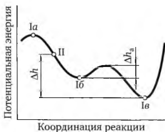
Рис. 4.1. Механическая модель системы, находящейся в лабильном состоянии (Iа), метастабильном (Iб) и стабильном (Iв) равновесиях, а также в нестабильном состоянии движения II
