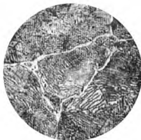
Рис. 6.3. Сталь У12. Пограничные выделения вторичного цементита в виде сплошной тонкой светлой сетки (матрица) по границам зерен бывшего аустенита, превратившегося при медленном охлаждении в крупнопластинчатый перлит
