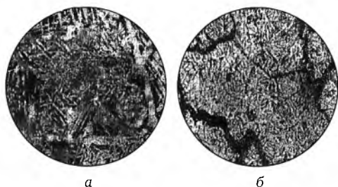
Рис. 8.3. Микроструктура перегретой (а) и пережженной (б) доэвтектоидной стали
