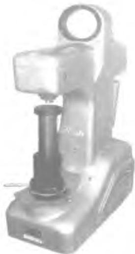
25-расм. Металлар ва қотишмаларнинг қаттиқлигини аниқлаш учун мўлжалланган ТК-2 Роквель прибори (қаттиқ металллар учун).
