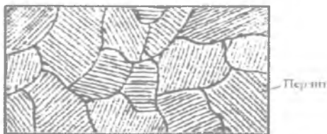
10.4-расм. Эвтектоидли пўлатнинг микроструктураси кўриниши.
