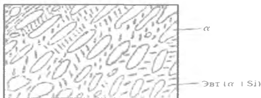
17.8-расм. Модификацияланган силуминнинг структурасининг схемаси.
