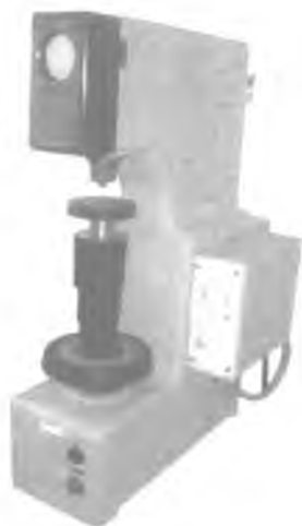
24-расм. Металлар ва қотишмаларнинг қаттиқлигини аниқлаш учун мўлжалланган ТБ5004 Бринель прибори (юмшоқ металллар учун).
