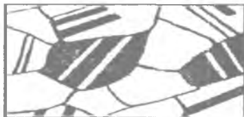
17.5-расм. Босим остида ишлов берилган ва юмшатишган бронзанинг структуравий схемаси
