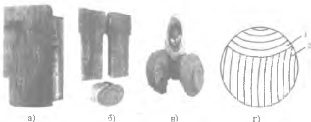
4.1-расм. Деталларнинг синиш турлари: қовушқоқ синиш (а); мўрт синиш (б); толиқиш оқибатида синиш (в) ва толиқиш синишнинг схемаси (г): 1 - дарзнинг ривожланиш зонаси; 2 - мўрт синиш зонаси.
