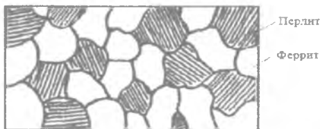
10.3-расм. Эвтектоидгача бўлган пўлатнинг микроструктура кўриниши.
