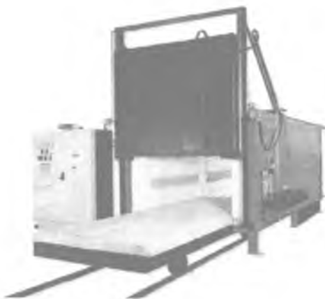
10-расм. Турли хил материалларни 500^{\circ}\text{C} ҳароратгача қиздириб, бушатиш электрошкаф қуритиш лаборатория печи СНОЛ - 3,5.3,5 3,5/3,5-И янги авлоди.
