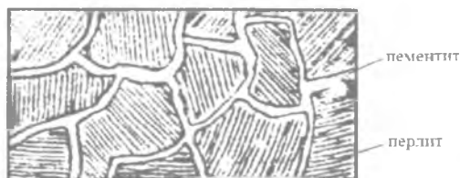
9.5-расм. Эвтектоиддан кейинги пўлатнинг микроструктураси кўриниши.
