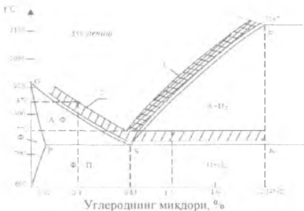
12.1-рasm. Fe-C ҳолат диаграммасининг пўлат қисми кўриниши.
