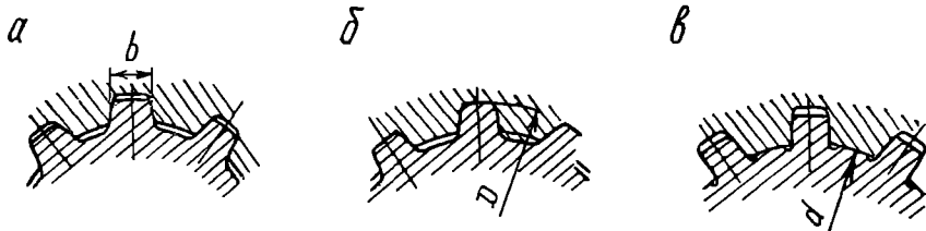
63- шакл. Тўғри тўртбурчакли шлиц ҳисобига марказлаштириш: а — ён ёқлари томонлари бўйича ; б — сиртқи диаметри бўйича ; в — ички диаметри бўйича
