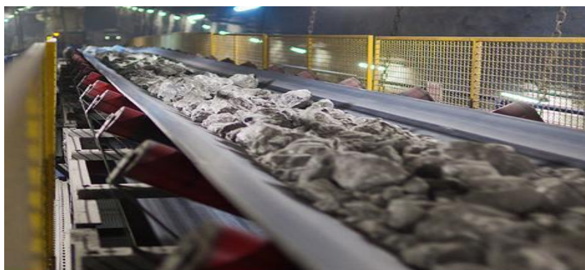
1.4 – rasm. Tasmali konveyerning sxemasi va ko'rinishi.
