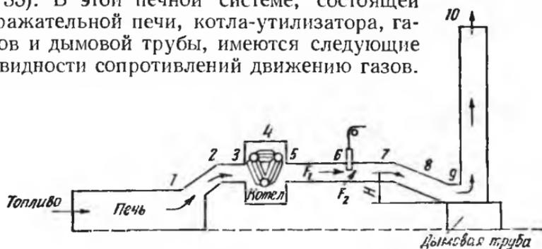
Рис. 35. Схема сопротивления движению газов
