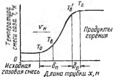
Рис. 110. Горение топлива по современной теории
