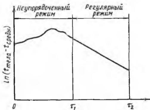
Рис. 81. Охлаждение тела при неупорядоченном и регулярном режиме
