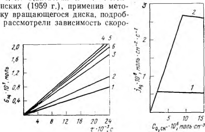
Рис. 27. Кинетические кривые растворения серебра ( t=25^\circ\text{C} , n=1100 об/мин) при C_{\text{KCN}} \cdot 10^6 моль · см -3 :
