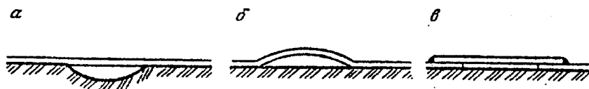
26.1-расм. Туб тагида бўртишлар ва бўшлиқлар ҳосил бўлганда тубларни таъмирлаш: а-пойдеворларнинг чўкиши натижасида туб тагида бўшлиқларнинг ҳосил бўлиши; б-тубда бўртишлар; в-таъмирланган майдон.
