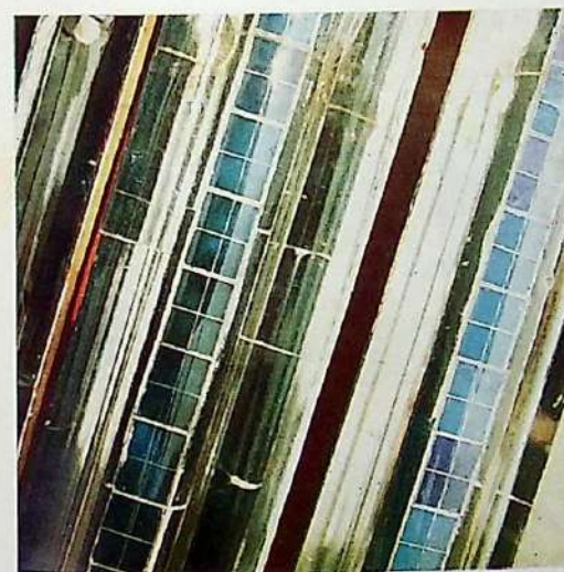
Рис. 3. Комбинированные фототермические преобразователи с солнечными элементами в вакуумированных оболочках крупным планом
