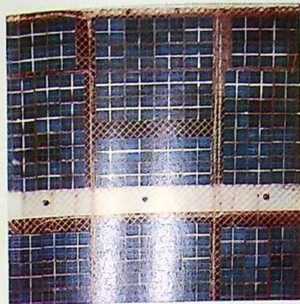
Рис. 1. Кремниевые солнечные батареи с зеркальными теплоотражающими покрытиями, прозрачные в инфракрасной области солнечного спектра, разработанные для советских межпланетных станций «Венера»
