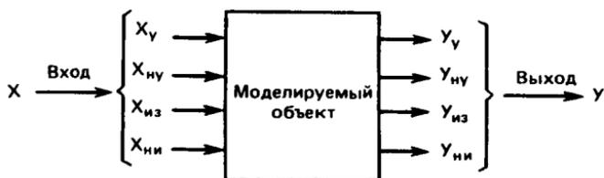
Рис. 5.1. Параметры моделируемой системы
