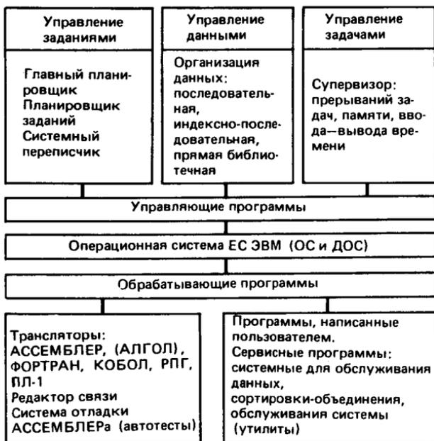
Рис. 2.8. Операционная система ЕС ЭВМ
