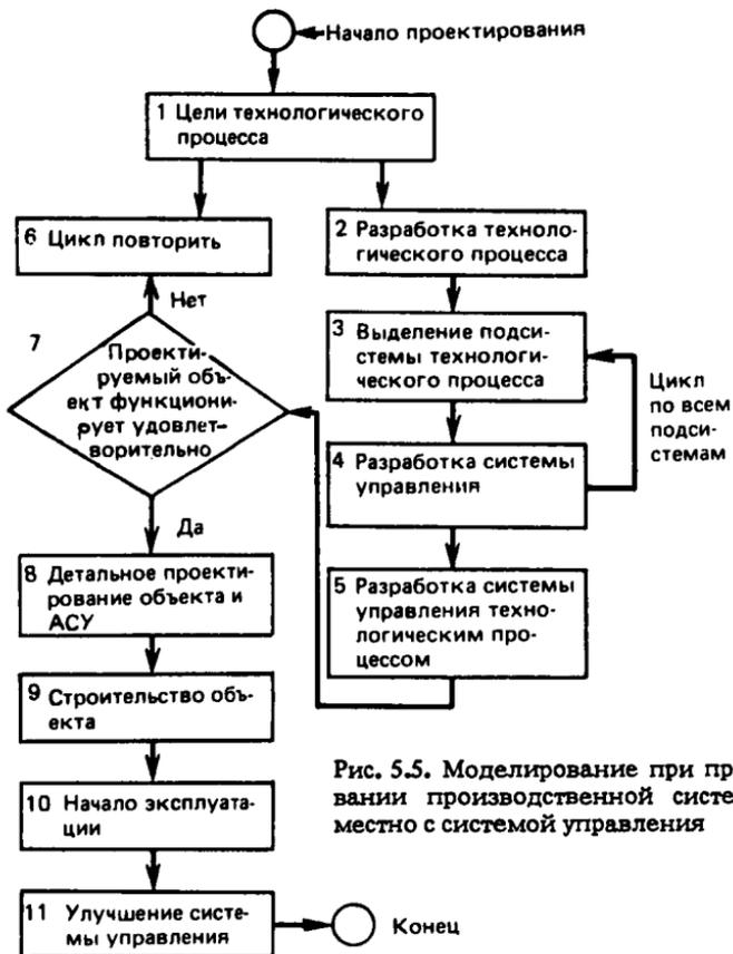
Рис. 5.5. Моделирование при проектировании производственной системы совместно с системой управления
