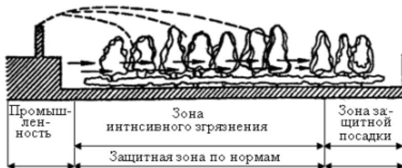
Рис. 5. Совмещенная схема движения загрязненных нижнего и верхнего потоков
