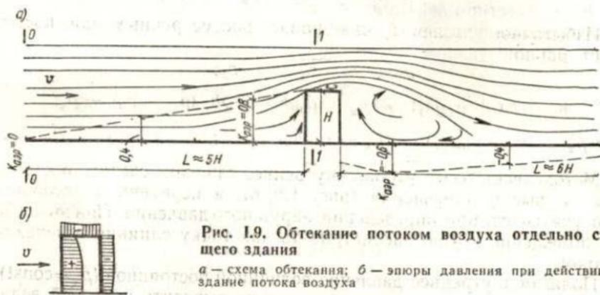
Рис. 1.9. Обтекание потоком воздуха отдельно стоящего здания
