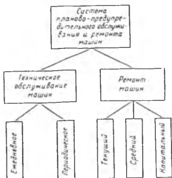
Рис. 3.1. Принципиальная схема системы ППР
