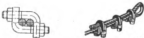
Рис 10.1 Крепление троса зажимными гайками и шайбами
