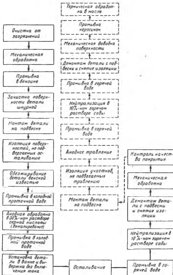
Рис. 2.5. Схема технологического процесса ремонта деталей осталиванием
