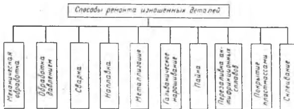
Рис. 6.1. Классификация способов ремонта изношенных деталей..
